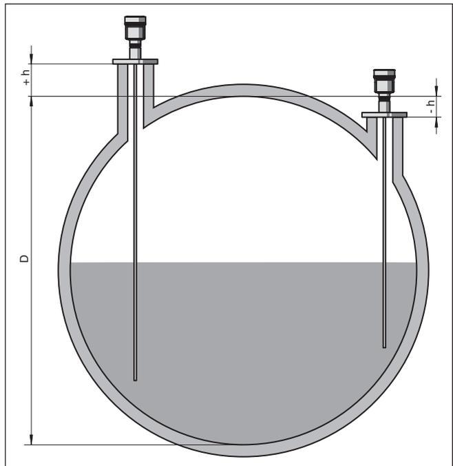
Fig. 19: Vessel height und socket correction value
